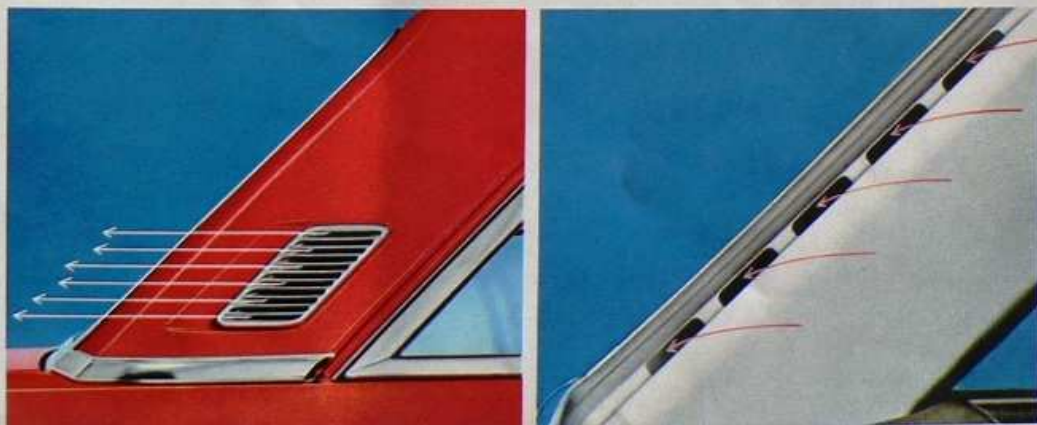
So sieht der Luftausgang im Innern des Taunus 20M aus.
